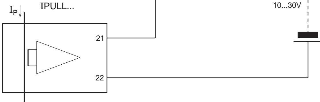
Anschlusschema eines passiven
